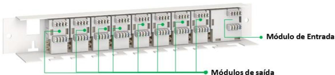
O módulo de entrada (ME) está interligado com os módulos de saída, através dos ligadores laterais, que garantem a continuidade do sinal de 2 operadores de voz, em todo o conjunto.
