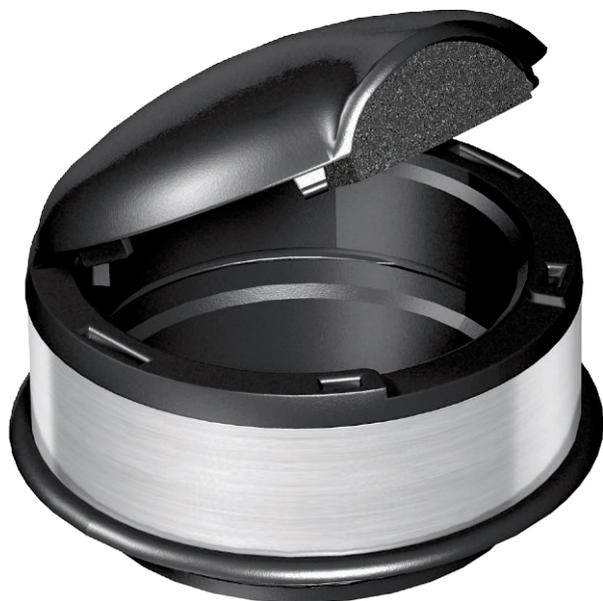
Tampa de proteção para utilização em caixa de pavimento UDL2-80 e saídas de chão para a saída de cabos com proteção, pavimentos limpos de modo húmido em área interior, com anel de nervuras reforçadas em poliamida, coberto através de um anel de V2A, com vedação em borracha para perfis.
